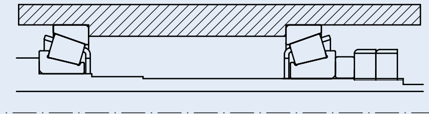
(d) Position preload without spacers
